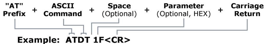
To read a parameter value stored in the RF module’s register, omit the parameter field.
